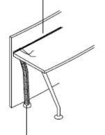
Vertebra passacavo Flexible cable-way Vertebre passe- cābles Vertebra de pasaje cables
